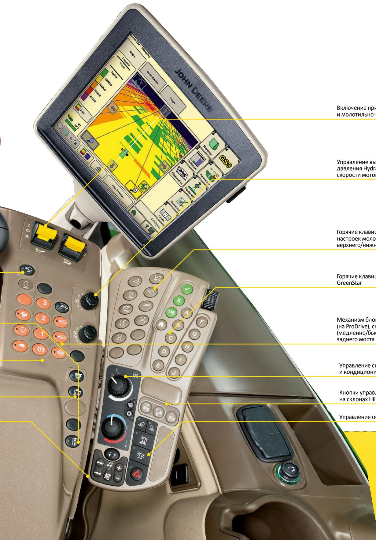
Включение привода жатки, реверса и молотильно-сепарирующей системы
