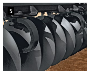
Уплотненные закрытые подшипники, не требующие обслуживания.
