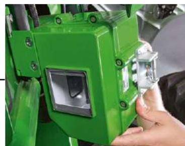
А изображение с высокоскоростной камеры ActiveVision, установленной возле шнека недомолоченных колосьев, позволяет в реальном времени наблюдать за содержимым недомолоченных колосьев и анализировать его.
