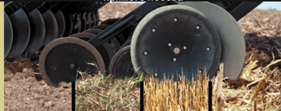
Новый однодисковый сошник для технологии прямого посева
