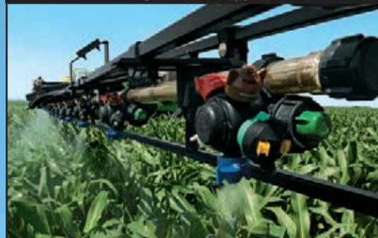
С помощью карт границ поля или прошлогодних данных о сборе урожая можно быстро и просто создать индивидуальные предписания для внесения химикатов с помощью системы GreenStar 2 и дисплея GS2 2600. Простые в использовании меню позволяют выбрать идеальное предписание, а контроллер скорости подачи опрыскивателя точно и автоматически выполнит дозирование распыляемого раствора.
