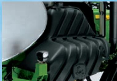
*Возможность промывки емкости до трех раз 568 литрами (150 галлонами) промывочной воды. Оператор может выбрать и включить цикл автоматической промывки из кабины одним нажатием кнопки.*
