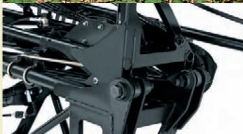
*Усиленные шарниры позволяют легко складывать штангу шириной 36,5 м (120 футов) для опрыскивания полосы шириной 21 или 27 м (70 или 90 футов); «трехмерная» конструкция означает, что ваши штанги останутся прямыми и ровными даже после многих сезонов активной эксплуатации. Независимые системы подвески помогают гасить вертикальные и горизонтальные движения.*
