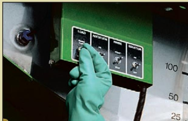
**Система управления раствором** (входит в стандартную комплектацию модели 4930) автоматически выполняет наполнение, промывку и замеры; вам только надо установить параметры на наружной панели управления или на дисплее GS2 2600 в кабине.
