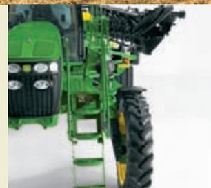
Гидравлически управляемая выдвижная лестница обеспечивает фронтальный доступ в кабину опрыскивателя – между штангой и капотом.
