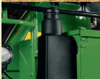
Топливный бак объемом 503 л позволяет в течение 16 часов работать без остановок.
