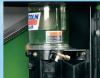
*Предлагается автоматизированная система смазки Lincoln Quicklub, автоматически смазывающая 75 точек смазки опрыскивателя в процессе опрыскивания.*
