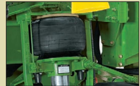
Автоматическая регулировка пневморессоры выравнивает корпус самоходного опрыскивателя 4830, обеспечивая непревзойденный комфорт оператора во время работы. Система контроля крутящего момента входит в стандартную комплектацию и помогает опрыскивателю 4830 справляться с тяжелыми условиями работы.
