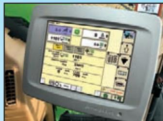
Монитор GS2 входит в стандартную комплектацию каждого самоходного опрыскивателя серии 30 и служит единым интерфейсом оператора, позволяющим использовать функции точной навигации, работы с картами, переменной скорости подачи раствора и управления штангой.
