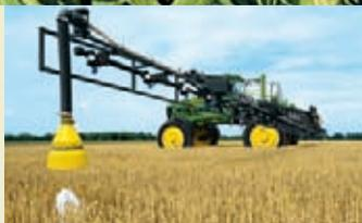
Каждый самоходный опрыскиватель серии 30 в стандартной комплектации поставляется со встроенным воздушным компрессором и пенообразователем объемом 189 л (50 галлонов).
