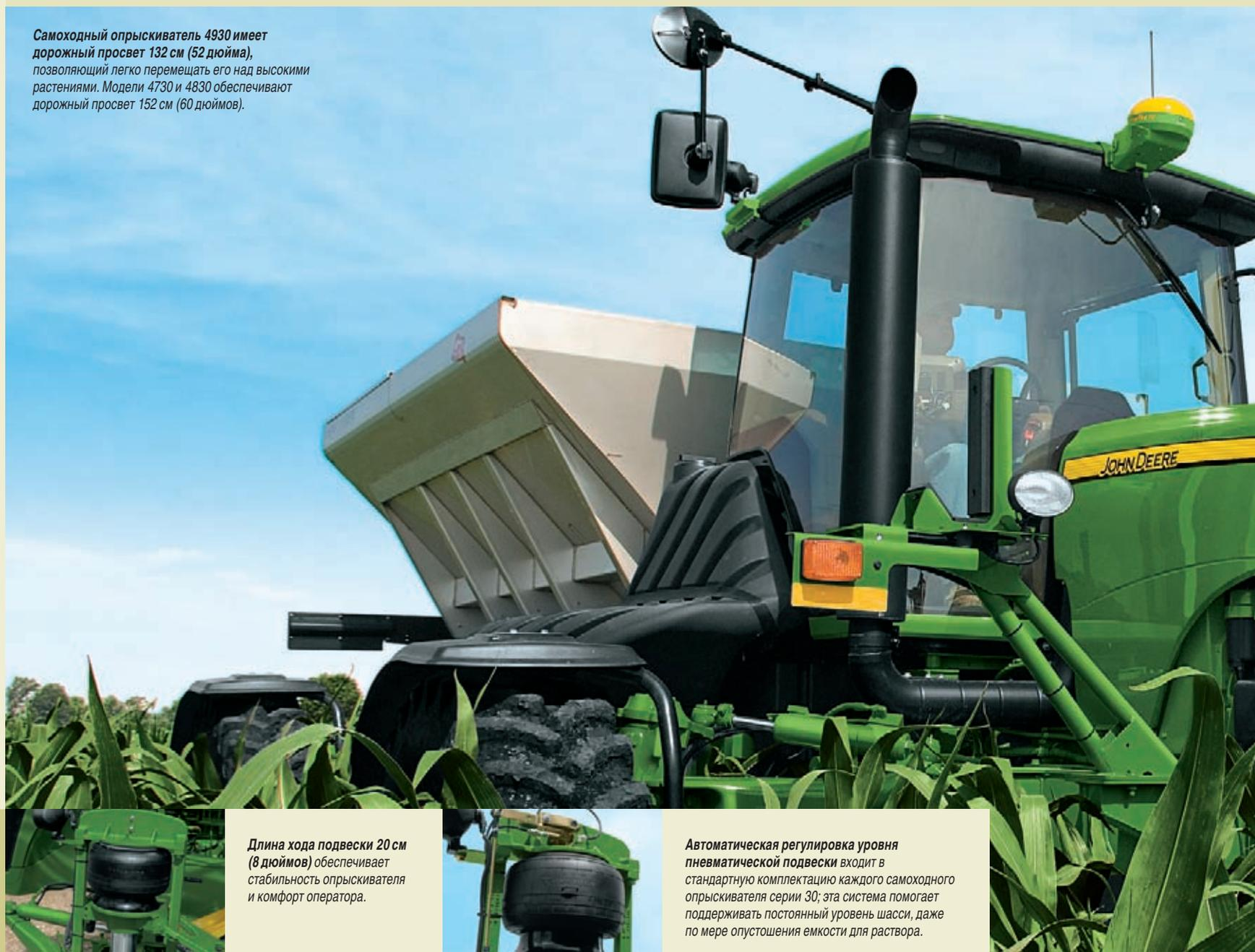
*Длина хода подвески 20 см (8 дюймов) обеспечивает стабильность опрыскивателя и комфорт оператора.*
