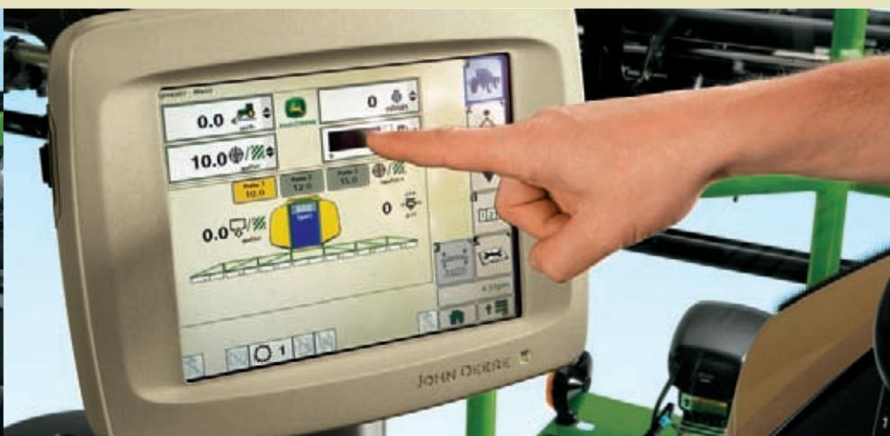
Дисплей GS2 2600 служит единым интерфейсом оператора; с помощью одного экрана оператор управляет всеми основными функциями машины, опрыскивания, навигации и регистрации. Полноцветный сенсорный дисплей настраивается исходя из наиболее важной для оператора информации.
