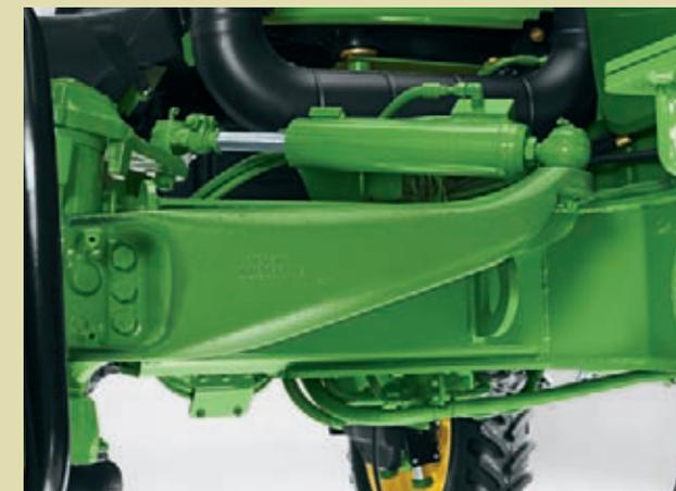
Усиленные детали шасси, подвески и системы рулевого управления сделаны из высокопрочной стали для обеспечения долговечности в экстремальных условиях. (ПОКАЗАНА МОДЕЛЬ 4930)
