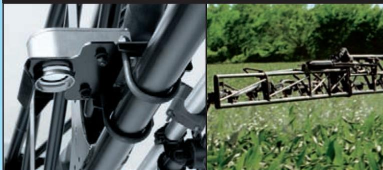
Чтобы обеспечить отличную эксплуатацию опрыскивателя без лишней нагрузки для оператора, закажите самоходный опрыскиватель серии 30 с системой автоматического управления уровнем штанги BoomTrac Pro. С помощью системы датчиков, работающих совместно с деталями существующей подвески штанги опрыскивателя, система BoomTrac Pro обеспечивает постоянную высоту штанги над уровнем растительного покрова, давая вам и вашим операторам возможность сосредоточиться на жизненно важных функциях машины.
