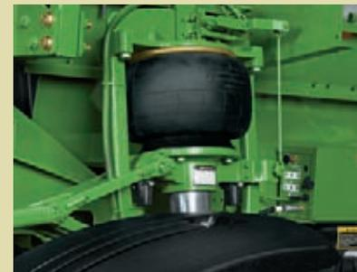
Подвеска шасси, созданная на основе авиационного опыта, а также три самостоятельные системы подвески штанги помогают обеспечивать постоянную высоту штанги над уровнем растительного покрова для более равномерного опрыскивания и сокращения скопления раствора, и при этом обеспечивают лучшие в отрасли комфорт и качество движения.
