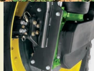
*Мощные дисковые тормоза обеспечивают быструю, плавную и управляемую остановку модели 4930. Управление основным тормозом встроено в гидравлическую ручку управления для удобного управления одной рукой.*
