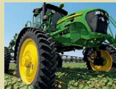
Меняйте ширину колеи одним нажатием кнопки, если вы закажете систему гидравлической регулировки ширины колеи. Передние и задние колеса можно установить на разном расстоянии друг от друга для снижения уплотнения почвы. Можно выбрать расстояние между центрами от 3 до 3,8 м (120 – 152 дюймов).
