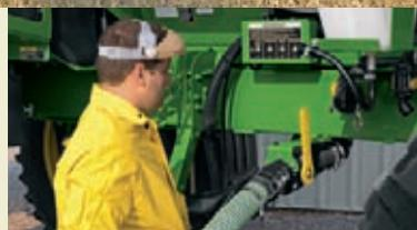
**Клапаны и наполнитель Quick Fill** находятся в зоне легкого доступа с уровня земли. Наполнитель диаметром 7,5 см (3 дюйма) входит в стандартную комплектацию, в качестве опции доступен наполнитель диаметром 5 см (2 дюйма).
