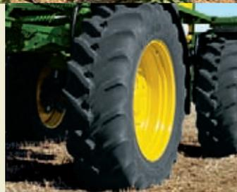
Поставляемые по заказу шины высокой проходимости позволяют вести машину по грязи или в других условиях плохого сцепления с грунтом.
