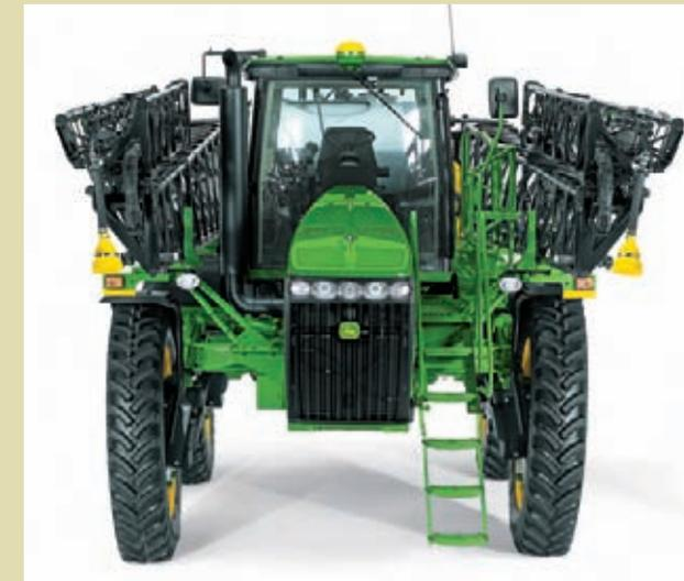
Гидравлическая регулировка колеи обеспечивает ширину колеи 305-386 см (120-152 дюйма) (модели 4730 и 4830) или 300-406 см (118-160 дюймов) (модель 4930), при ширине посадочной полосы 81, 86, 91, 97, 102 см (32, 34, 36, 38, 40 дюймов).
