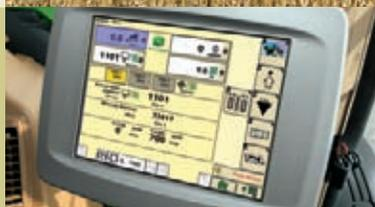
Контроллер скорости подачи раствора **SprayStar** интегрирован с дисплеем GS2 2600, что обеспечивает единый интерфейс практически для любого аспекта эксплуатации опрыскивателя.
