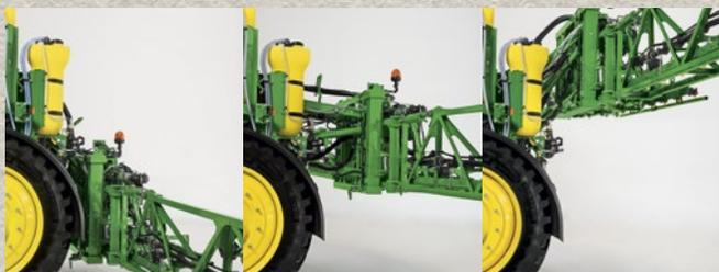
**Высота штанги** легко регулируется с 0,5 м до 2,3 м в зависимости от Ваших потребностей. Функция возврата штанги возвращает штангу обратно на ту же высоту опрыскивания после каждого преодоления препятствий на поле или поворота на защитной полосе. Это помогает обеспечить стабильную высоту опрыскивания. В зависимости от шасси и размера шин данная высота может незначительно варьироваться.
