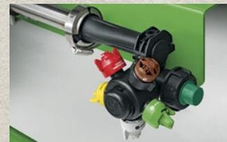
**Торцевая крышка аспирантов** на конце каждой секции опрыскивателя сокращает время выключения форсунки на 85% и устраняет глухие концы, в которых могут собираться ненужные остатки продукта. Поставляются стандартная и высоконапорная модификации (нержавеющая сталь или пластмасса). Эта функция позволяет устранить глухие концы и исключить скопление воздуха.
