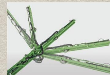
**Трехсторонняя защита наконечника штанги** защищает штангу от повреждений. При соприкосновении с препятствием наконечник может складываться на 80° вперед/назад и 15° вверх. Смещенная секция возвращается на место автоматически. Полное смещение штанги составляет 34°. Все форсунки заключены внутри конструкции штанги.
