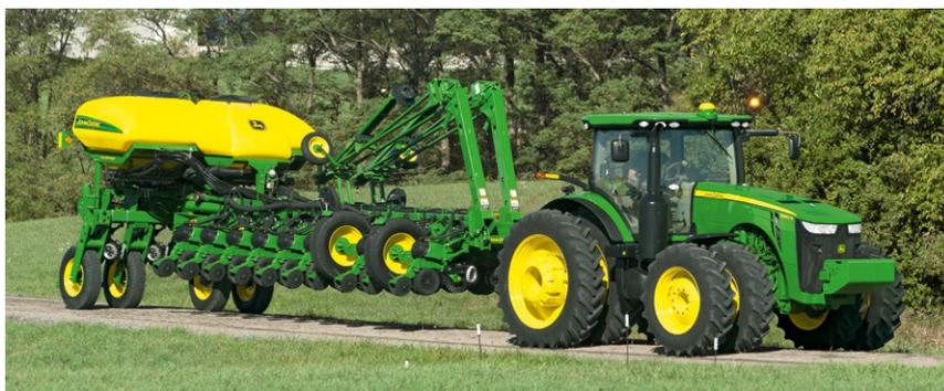
Перемещайтесь между полями, не беспокоясь о транспортировке. Даже с опциональной системой CCS сеялки точного высева 1775NT в транспортном режиме не превышают 3,7 м в ширину, так что пересечение мостов не является проблемой. Расположение баков на раме было оптимизировано для достижения наилучшего распределения веса при работах в поле.
