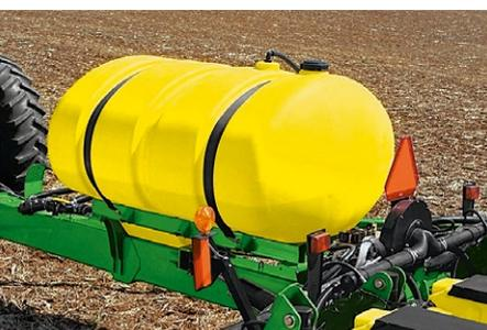
Бак с жидкими удобрениями устанавливается на тяговом брусе 1775NT или 1795\*. 12/24-рядная модель 1795 поставляется с баком объемом 1700 л. Расположенный центрально бак для удобрений на 2270 литров доступен на сеялках точного высева 1775NT на 24 ряда.
