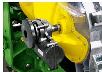
Система RowCommand управляет подачей семян с помощью муфты внутри каждого редуктора привода Pro-Shaft. Более прочный корпус создает защиту от препятствий и обеспечивает продолжительную работу без поломок.
