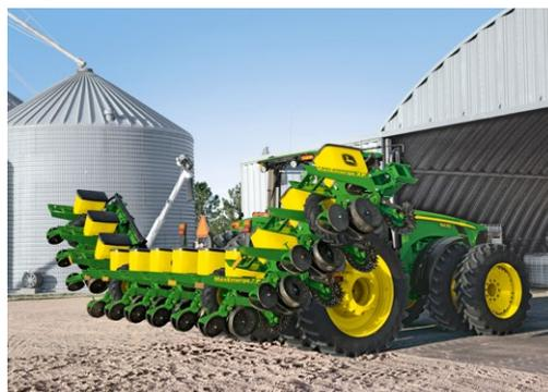
Для удобства транспортировки 12-рядная вертикально складывающаяся сеялка точного высева перемещается на компактном агрегате в сложенном состоянии.
