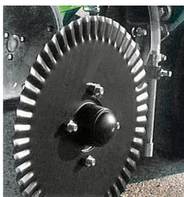
Устанавливаемый на высевальную секцию однодисковый сошник системы внесения жидких удобрений использует один 50-реберный рифленый дисковый нож для проникновения в твердый грунт. Жидкие удобрения вносятся в почву непосредственно за дисковым ножом.
