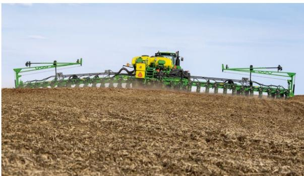
Все сеялки точного высева серии DB обладают прекрасной гибкостью для получения одинаковой глубины посева при работе на неровной местности. Каждая боковая секция движется на 15 градусов вверх и вниз относительно центральной секции сеялки.
