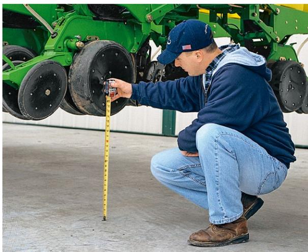
Только посмотрите на этот зазор под рамой! Расстояние от сошников до земли, составляющее почти 60 см, позволяет без труда преодолевать железнодорожные пути, выбоины на дорогах и другие препятствия, которые могут повредить расположенные близко к земле компоненты при движении по неровным полевым дорогам.
