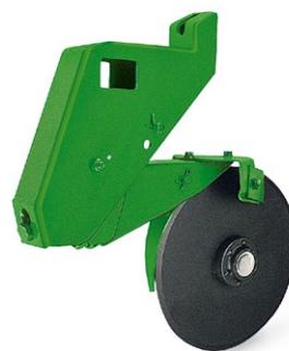
Этот двухдисковый сошник с креплением на раме идеально подходит для полей, обрабатываемых по традиционной технологии, а также для полей, требующих неглубокой обработки почвы. (Несовместим с устанавливаемым на раму дисковым ножом.)
