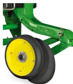
Однодисковый сошник для удобрений работает хорошо на необработанных и требующих неглубокой обработки почвах, а также на обычных полях с плотным грунтом. Резиновое колесо диаметром 33 см поддерживает глубину и сводит к минимуму разрушение почвы. Литой лоток не дает почве попадать в борозду до подачи удобрений.
