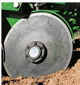
Устанавливаемые на высевальной секции двухдисковые сошники для жидких удобрений меньше разрушают почву. Удобрения могут быть внесены даже на глубину семян или ниже. Сошник может быть установлен на расстоянии до 5 и 7 см от рядка. Идеально подходит для полей, обработанных по традиционной технологии, требующих неглубокой обработки и легких необработанных полей.
