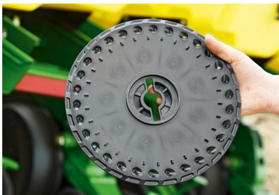
Вакуумный дозатор семян всасывает и удерживает отдельные семена в отверстиях высевашего диска, контролируя плотность и точность посева. Таким образом, скорость может быстро изменяться, а операторы могут выбирать из 50 различных скоростей посева.
