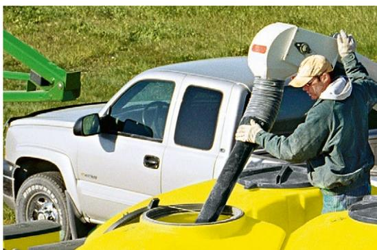
**Зерновой бак наполняется семенами, пока не будет покрыт подающий семяпровод.** Когда отверстие сужается, поток семян через семяпровод прекращается. Поток воздуха в высевающей секции направляется в ящик для семян и выходит через вентиляционное отверстие. По мере того, как семена захватываются дозатором и высеваются, их уровень в баке снижается, пока не откроется конец подающего семяпровода. В этот момент поток воздуха и подача семян возобновляются, и запас семян в ящике для семян пополняется.
