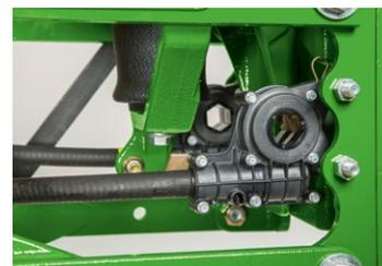
Имеющуюся у вас сеялку точного высева можно усовершенствовать, установив систему RowCommand! Комплект для переоборудования в полевых условиях предлагается для большинства сеялок точного высева, оснащенных приводами Pro-Shaft. Для переоборудования вам также понадобятся жгут проводки на основной раме сеялки, контроллер SeedStar 2 и дополнительный жгут проводки CAN.
