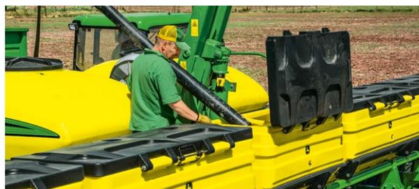
Объем до 2400 кг удобрений и 2466 кг семян для системы CCS и 1690 кг для ящика для семян специальной конструкции позволяет дольше оставаться в поле без необходимости заправлять сеялку. Простота установки и быстрый переход от транспортного к рабочему режиму, а также быстрый подъем и опускание высевальных секций на разворотной полосе поля позволяет увеличить надежность, необходимую для завершения посевных работ в срок.
