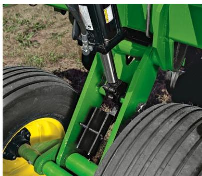
Большие копирующие боковых секций позволяют сеялке DB плавно перемещаться по поверхности почвы, а ширина колеи улучшает поток пожнивных остатков. В целях безопасности цилиндры крыла оборудованы блокировочными кронштейнами.
