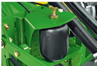
Пневматическая прижимная система позволяет регулировать прижимное усилие в соответствии с рабочими условиями.
