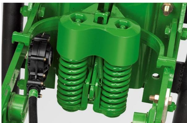
Регулируемые усиленные прижимные пружины (слева) позволяют устранить подпрыгивание высевочных секций на полях с большим количеством пожнивных остатков или на твердой почве. Прижимное усилие можно регулировать в четырех положениях – 0, 57, 114 или 182 кг на каждую высевочную секцию. Для изменения настроек специальных инструментов не требуется.
