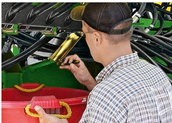
**Чтобы опустошить баки с семенами,** просто откройте выпускные отверстия в нижней части баков. Ровная коническая поверхность за ними позволяет выполнить полную очистку.
