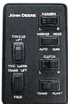
Простой в использовании блок управления позволяет складывать и раскладывать сеялку DB из кабины трактора.
