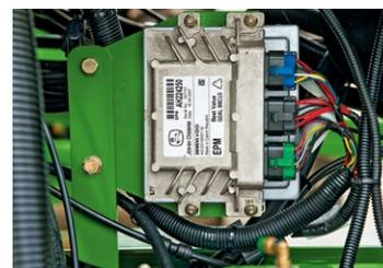
Этот электронный блок питания – сердце системы RowCommand. Низковольтные сигналы по шине CAN контролируют подачу сигнала на нужный привод Pro-Shaft. Кроме того, система имеет функцию защиты от ошибки: при отказе муфты дозатор продолжает высев.
