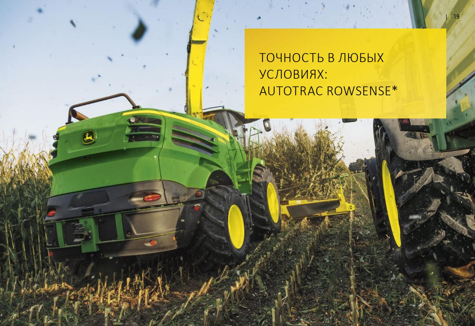
Получите максимальную отдачу от затраченного времени, а также Ваших посевов кукурузы, с помощью системы AutoTrac RowSense. Предназначенная для комбайнов и кормоуборочных комбайнов с поддержкой AutoTrac, эта передовая технология одновременно использует данные с датчика направления по рядкам и данные позиционирования по спутнику с приемника StarFire, что позволяет повысить производительность.
