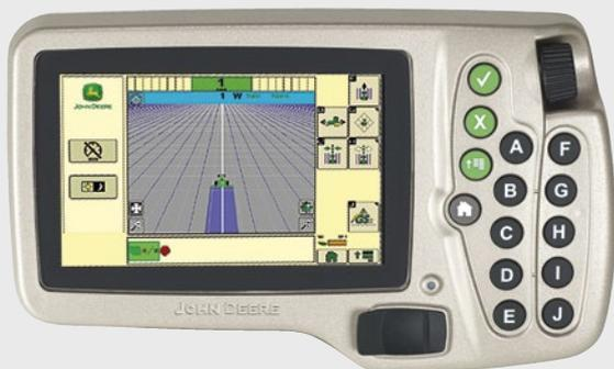
Идеальный дисплей начального уровня с мастером настройки не может быть проще в использовании. Колесо прокрутки служит для удобства навигации, а десять буквенных клавиш обеспечивают управление одним нажатием. Основные возможности документирования включают вывод данных в формате PDF с итоговой информацией о работах, а для передачи данных используется USB порт.
