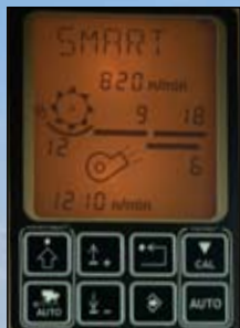
Регулировки системы Harvest Smart осуществляются на мониторе, расположенном на угловой стойке.
