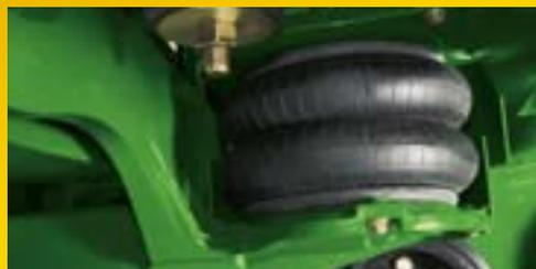
Пневматические подушки спереди и позади поворотного рычага способствуют смягчению ударов.
