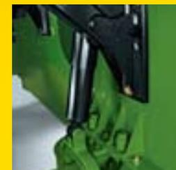
Усиленный амортизатор обеспечивает дополнительное демпфирование.
