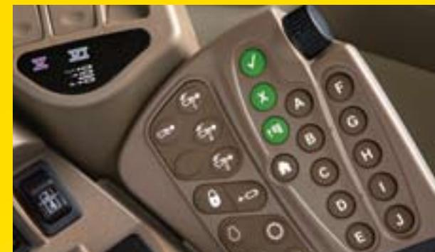
Система AutoLoad контролируется при помощи органов управления клапанами секционного гидрораспределителя и функции контроля глубины TouchSet.
