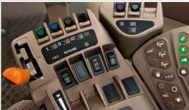
Для удобства управления на панели CommandARM имеется до шести кнопок управления клапанами секционного гидрораспределителя (например, для работы тандемных скреперов); если эти кнопки не используются, специальная крышка предотвращает случайное нажатие.
