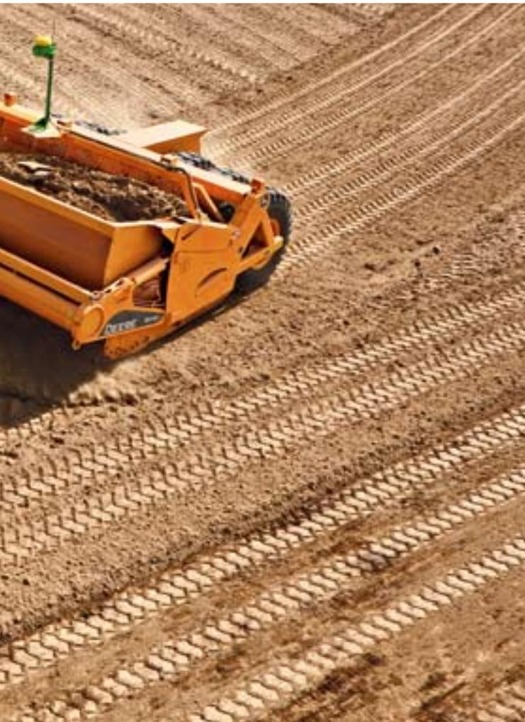
Система автоматического управления скрепером AutoLoad является идеальным эксклюзивным решением John Deere для работы скреперов, агрегируемых с тракторами.
