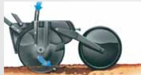
Стойки TruPosition для сеялки модели 730 поставляются в качестве опции. Они имеют усилие срабатывания 90,7 кг и ход 25 см, что позволяет с лёгкостью преодолевать препятствия. Эти стойки устойчивы к боковому смещению, что позволяет производить выравнивание семенного ложа оптимальным образом.
