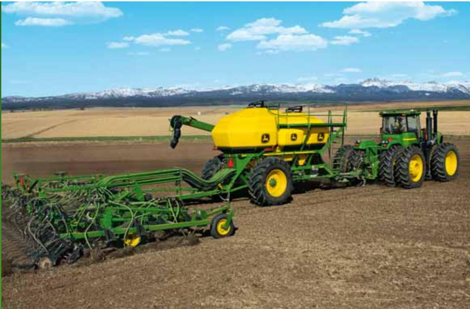
Рама сеялки 730LL очень схожа с полевым культиватором модели 2210. Эта рама обеспечивает превосходную поддержку и гибкость при работе на неровном рельефе. Компоненты рамы, включая поворотный вал, установленный в передней части, рама с конфигурацией «труба в трубе», а также высота рамы – всё это способствует поддержанию более высокой рабочей скорости и соблюдению постоянного контроля глубины.
