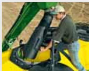
**Телескопический желоб** на конвейере и на 20-сантиметровом шнеке позволяет заполнять бункеры до самого верха для максимальной производительности работы. Вы также можете отрегулировать положение рукава в соответствии с высотой каждого бункера.
