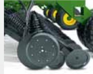
**Усиленные сошники** гарантируют отличную работу сеялки 1890 по нулевой технологии. Они обеспечивают отличное заглубление и отличаются повышенной надёжностью по сравнению с предыдущими сошниками, благодаря цельному высевающему башмаку, который защищён диском.
