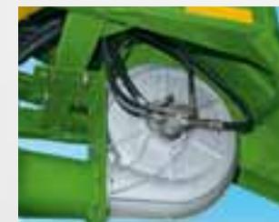
**Этот гидравлический мотор** приводит во вращение большой вентилятор диаметром 45 см. Вентилятор перемещает до 567 кг/га, используя большой объём воздуха при более медленных скоростях, что минимизирует повреждение семян.
