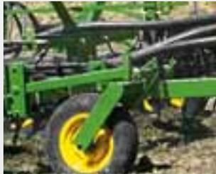
Для обеспечения устойчивости в поле в базовой комплектации предлагаются опорные колёса, устанавливаемые на передней части сеялки. Для удобства продольного выравнивания сеялка оснащается домкратом.
