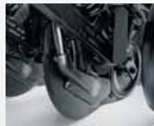
Цельные высевальные башмаки изготовлены из чугуна для большей надёжности. Нейлоновый семенной отражатель направляет семена на дно борозды, обеспечивая их контакт с почвой. В качестве опции предлагается высевальный башмак из хромистого сплава, который имеет срок службы, увеличенный в три раза.
