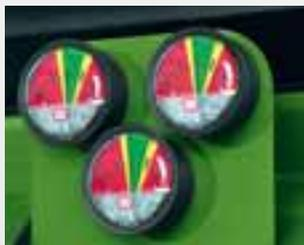
**Индикаторы положения крышек** позволяют с одного взгляда проверить, что крышки бункеров плотно закрыты. Цветной датчик для каждого бункера сигнализирует о невозможности продолжения работы, если одна из крышек остаётся открытой.
