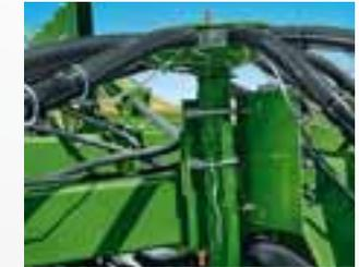
Для своевременного отслеживания забивания во время посева установите датчики, сигнализирующие о забивании. В системе сигнализации о забивании первичных семяпроводов датчик устанавливается на один из семяпроводов каждой башни. В системе сигнализации о забивании всех семяпроводов датчик устанавливается на каждый вторичный семяпровод.
