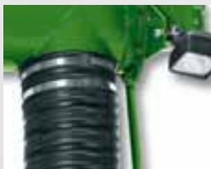
**Система освещения, предлагаемая в качестве опции**, делает процесс заправки бункеров ночью лёгкой задачей. Две 35-ваттные галогенные лампы обеспечивают достаточное освещение для загрузки бункеров, настройки высевающих аппаратов или проверки бункеров даже после захода солнца.
