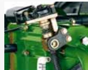
**Вы можете изменять норму высева, используя регулирующую ручку** или с помощью системы изменения нормы внесения, предлагаемой в качестве опции, прямо из кабины.
