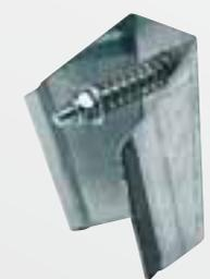
Этот чистик обеспечивает качественную очистку, воздействуя между лезвиями дисковых сошников. Нержавеющая гальванизированная сталь и карбидовольфрамовые накладки обеспечивают повышенный срок службы чистиков.
