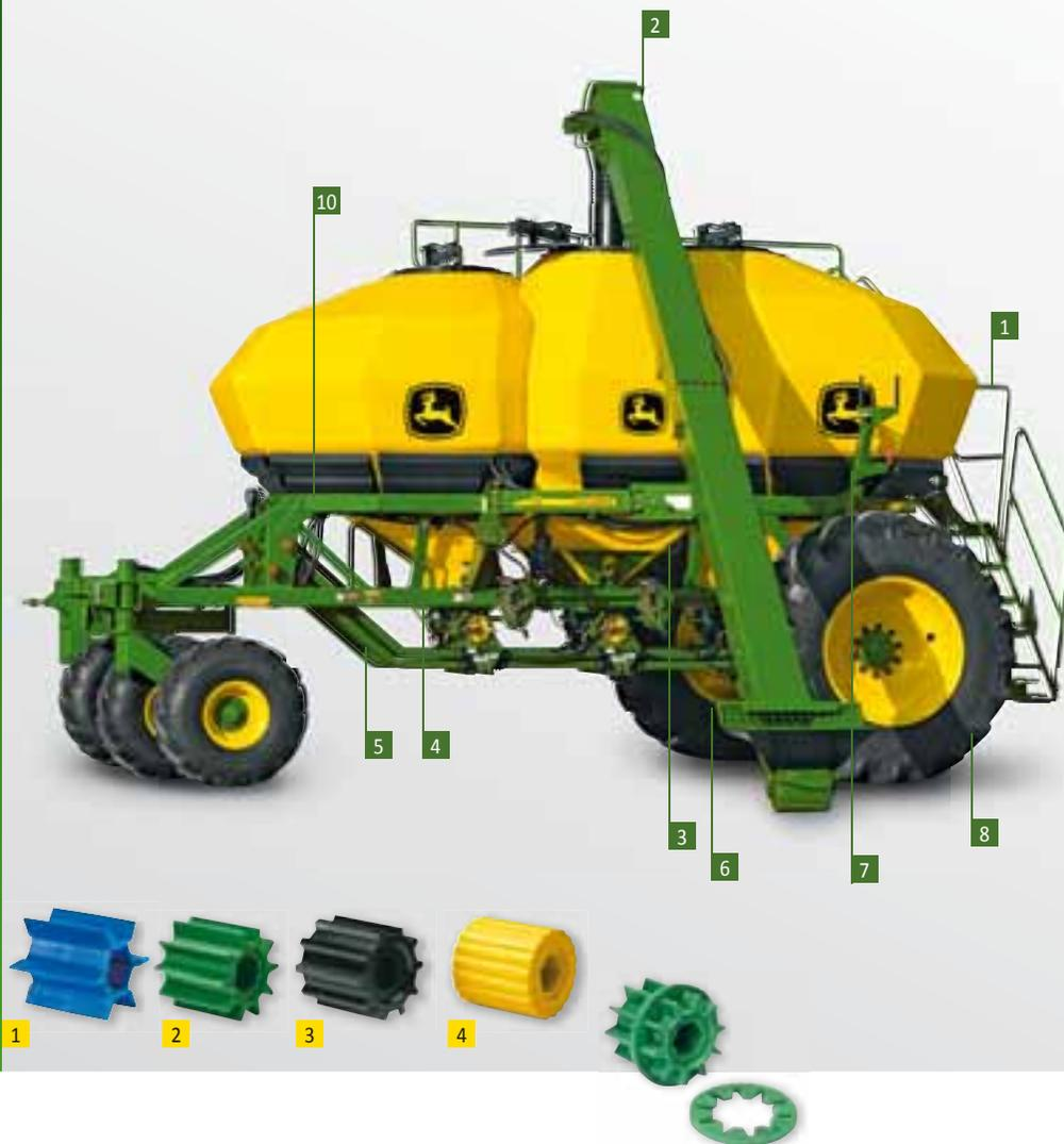
**1** Удобная лестница ведёт Вас к устойчивой платформе. Отсюда крышки бункеров находятся на расстоянии вытянутой руки. Диаметр крышек (27 см) обеспечивает лёгкий доступ к внутренним лестницам. Расстояние между центрами крышек составляет всего лишь 1,5 м, что позволяет с лёгкостью переустанавливать шнек или конвейер, находясь на платформе.
