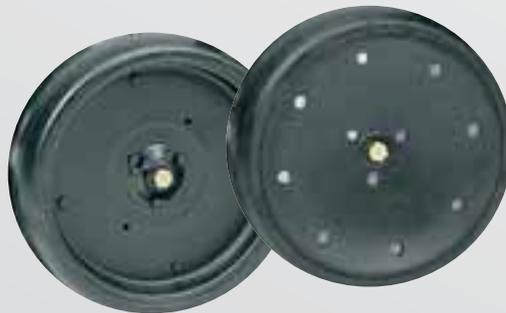
Для сеялки 1895 Вы можете выбрать **стальные (стандартная комплектация) или копирующие колёса с гладким ободом.** Стальные копирующие колёса идеально подходят для работы по традиционной технологии, в то время как копирующие колёса с гладким ободом лучше подходят для рыхлой, обработанной почвы, так как минимизируют разбрасывание почвы. Оба типа колёс имеют ширину 11,4 см; также пластиковые колёса могут иметь ширину 7,6 см.
