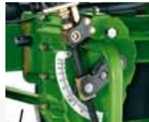
**Система контроля переменной нормы внесения SeedStar** позволяет увеличивать или уменьшать нормы внесения семян/удобрений прямо из кабины трактора. Внутри три обгонные муфты обеспечивают постоянную подачу мощности к высевающим катушкам при любой норме высева.
