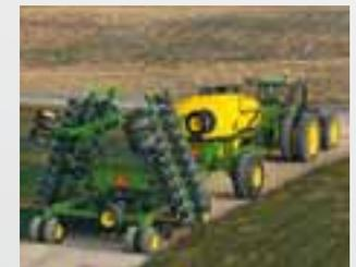
**Транспортировка сеялки 1890 с поля на поле производится быстро и легко.** Ширина 9- и 11-метровой сеялок в сложенном виде составляет 4,37 м. Ширина 12- и 13-метровой сеялок в сложенном виде – 5,59 м.
