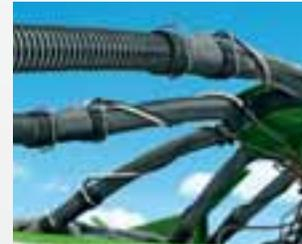
Контроль работы каждого ряда сошников производится с помощью **рентабельной системы датчиков забивания, предлагаемой в качестве опции.**
