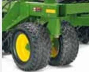
**Сдвоенные шины** на центральной раме и боковых секциях, необходимые для повышенной проходимости, входят в стандартную комплектацию (на фотографии представлены шины 31x13,5, диаметром 38 см, предлагаемые в качестве опции).
