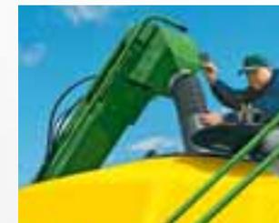
**Загрузчик семян конвейерного типа** оставляет треснутые и раздробленные семена в прошлом. По сравнению с загрузчиком семян шнекового типа объём поврежденных семян снижается на величину от 0,02 до 2,8%. Для лучшего продвижения семян скребки на конвейерной ленте расположены через каждые 15 см.
