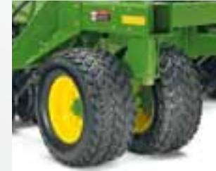
**Для ещё большей устойчивости и улучшения проходимости** сеялка 1890 оборудована четырьмя парами колёс на центральной раме и одинарными колёсами на боковых секциях (сдвоенные колёса предлагаются в качестве опции). Для простоты сервисного обслуживания колёс предлагается новая втулка на болтах в сборе копирующего колеса.
