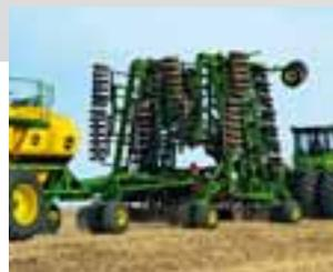
Пневматические сеялки моделей 1830 и 1835 складываются до минимальной ширины для транспортировки.
