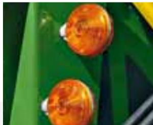
**Жёлтые фонари** выполняют две задачи. Когда система SeedStar работает в режиме «Установка скорости вентилятора», оба фонаря включены, если скорость вентилятора находится в пределах 5% от запрограммированной. Если горит только один из фонарей, скорость находится выше или ниже заданного уровня. При заполнении чередующиеся вспышки фонарей указывают на то, что бункер полон.
