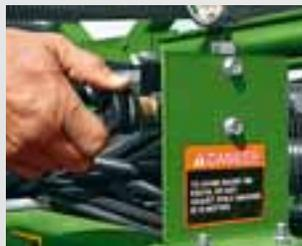
Система активного гидравлического заглубления (ниже) позволяет с помощью вращения рукоятки легко задать прижимное усилие (до 47,6 кг на сошник) для создания борозды и последующего прикатывания почвы над семенами.
