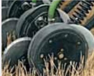
**Дисковый сошник для раздельного внесения удобрений** имеет активное заглубление, контроль глубины заделки, минимально разбивает почву и пожнив-ные остатки, а также систему заделки борозды для закрывания сухих, жидких или газообразных удобрений.
